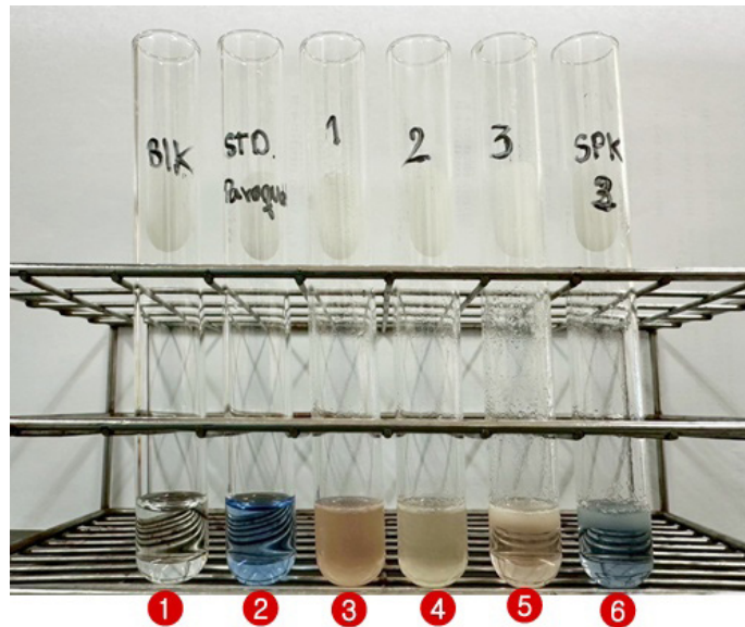
รูปที่ 5-4 การตรวจหาพาราควอตโดยวิธี Color test
