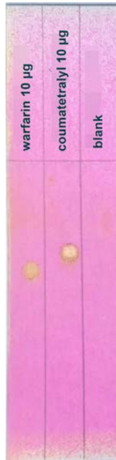
รูปที่ 6-6 TLC chromatogram ของสารละลายมาตรฐาน warfarin และ coumatetralyl
