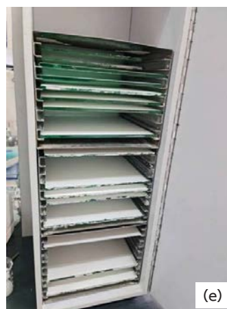
รูปที่ 3-5 วิธีการ coat plate (a) Silica gel 60 GF 254 และน้ำกลั่น (b) เช็ดกระจกด้วย acetone (c) เท Silica gel 60 GF 254 ที่ผสมด้วยน้ำกลั่นลงใน Moveable spreader (d) ค่อยๆลาก Moveable spreader ไปข้างหน้าสุดทาง และ (e) TLC ที่อบเรียบร้อยแล้ว เก็บในตู้เก็บ TLC plate
