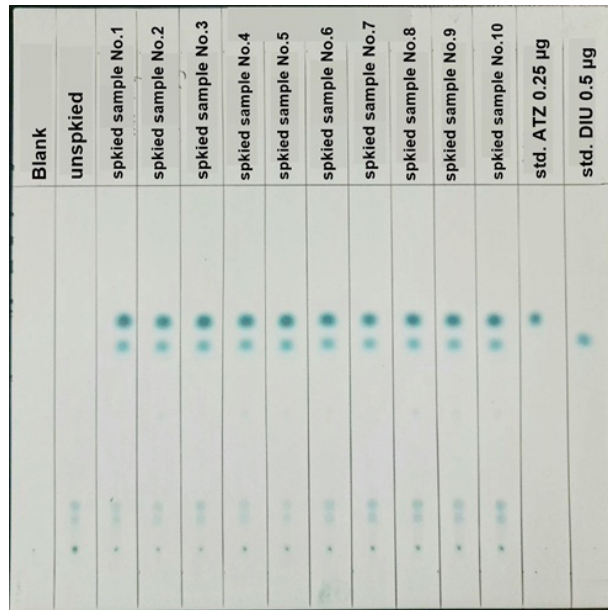
รูปที่ 5-3 TLC Chromatogram ของการหาค่า LOD ของวิธี ด้วยการทำให้ spiked sample (n=10) โดยใช้ system chloroform : acetone (7:3) และพ่นด้วย o-TKI reagent
