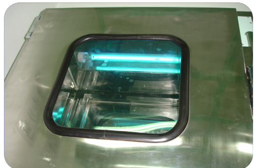
รูปที่ 11.4 ระบบจะตั้งให้ UV ทำงาน 20 นาที เมื่อปิดประตูจากด้าน secure zone
