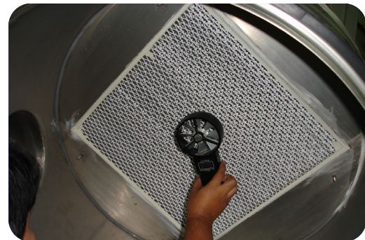
รูปที่ 5.2 การตรวจเช็คความเร็วลม HEPA filter ด้วย anemometer
