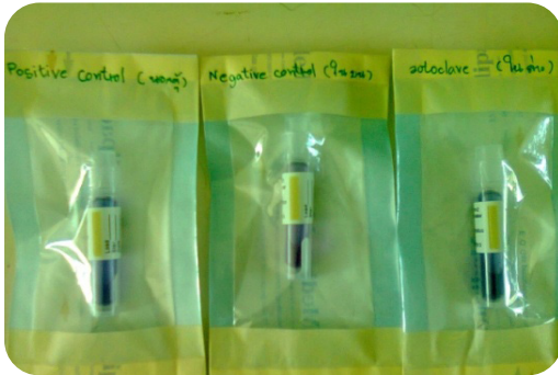
รูปที่ 7.1 เตรียม Biological test ใส่ห่อหนึ่งที่ให้ความร้อนหรือกึ่งผ่านได้
