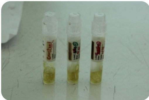
รูปที่ 7.3 ผล biological test ที่ให้ผลบวกจะมีสีเหลืองตามคำบ่งชี้ของบริษัท
