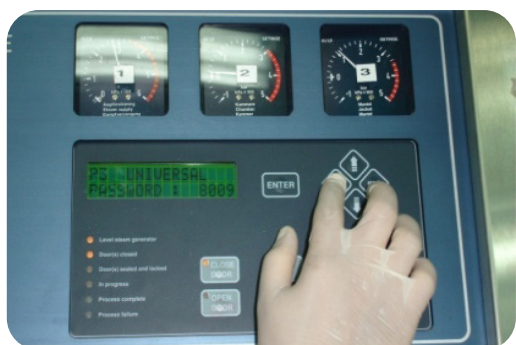
รูปที่ 6.5 ใส่รหัสเครื่องนึ่งฆ่าเชื้อ เลือกโปรแกรม ก่อนกดปุ่มเริ่มทำงาน
