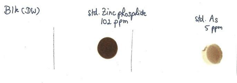
รูปที่ 5-8 ผลบวกของสารมาตรฐาน Zinc phosphide และ As จากการตรวจวิเคราะห์หาสารกำจัดหนู โดย Gutzeit's test
