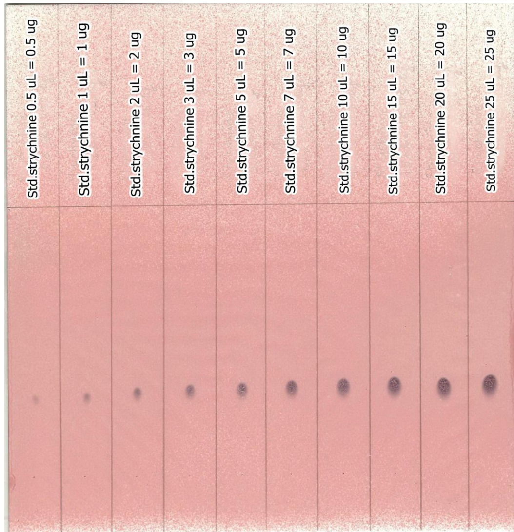
รูปที่ 5-2 TLC chromatogram ของสารละลายมาตรฐาน strychnine ที่ปริมาณต่าง ๆ กัน
