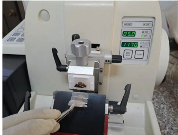
รูปที่ 69 การตัดบล็อกเนื้อเยื่อด้วยเครื่อง microtome
