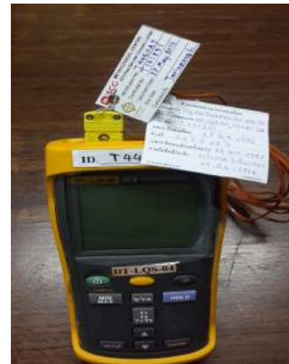
รูปที่ 4 เครื่องมือในห้องปฏิบัติการ มีการบ่งชี้สถานะการตรวจสอบ เทียบเครื่องมือ
