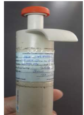
รูปที่ 4 เครื่องมือในห้องปฏิบัติการ มีการบ่งชี้สถานะการตรวจสอบ เทียบเครื่องมือ
