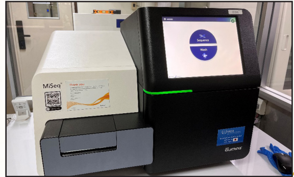
รูปที่ 1 เครื่องถอดรหัสพันธุกรรมด้วยเทคโนโลยี short-read sequencing รุ่น MiSeq (Illumina, USA)
